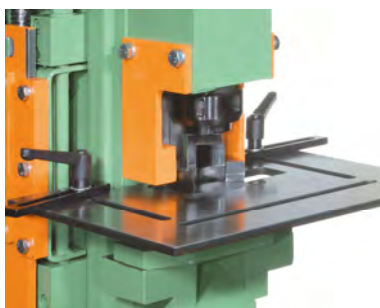
703 pour le poste de grugeage: dispositif spécial pour poinçon n° 7, matrice n° 7, équipé d'un outil à gruger les angles, rayon d'arrondissement R = 35 mm
