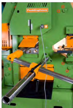
522 elektrischer Längenanschlag 1 Meter 2 Meter 3 Meter
