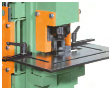
703 für die Ausklinkerseite: Sonderaufnahme für Stempel Nr. 7, Matrize Nr. 6, ausgestattet mit Eckenabrundwerkzeug, R = 35 mm
